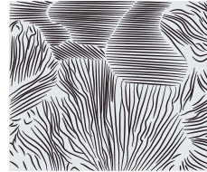
perliet ( \alpha -ijzer/cementiet)
